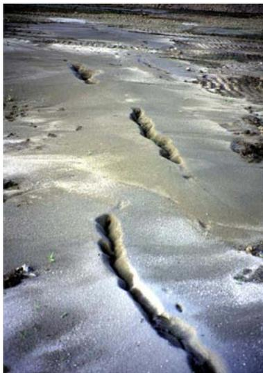
写真 2.6 亀裂から噴出した液状液状化砂（宮城県鳴瀬町樋場）
