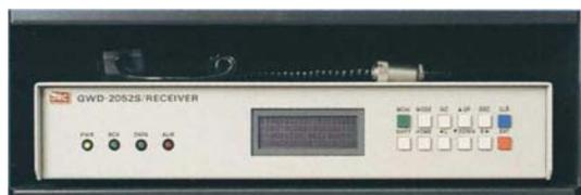
写真 3.1 志津川町役場に設置されている緊急情報衛星同報受信装置
