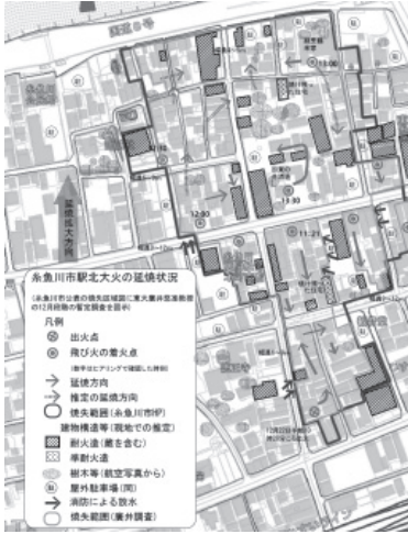
調査によって得られた延焼状況 (推測含む、速報)
