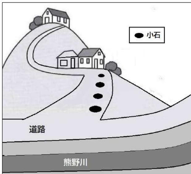
図 2: 自宅までの上り坂に等間隔に置いた小石の水没状況の監視を行い浸水範囲や浸水に至る時間を推測
