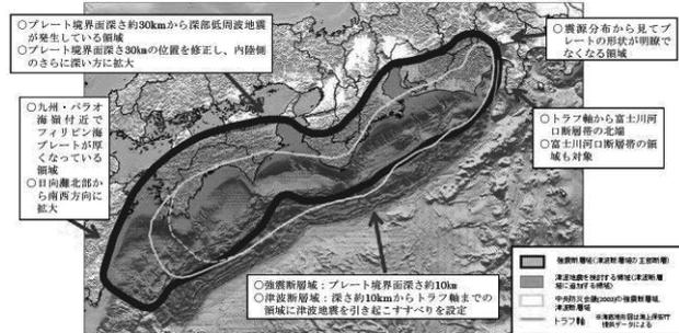
図-3 南海トラフ沿いで想定される最大クラスの地震・津波の震源域（内閣府資料より）
